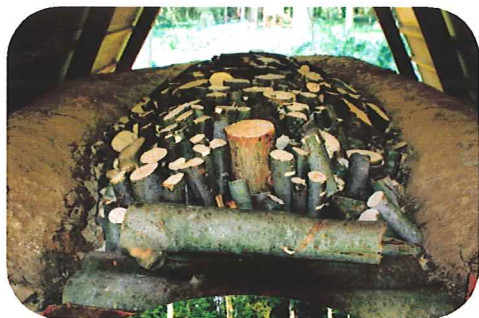
炭窯に材料が詰まり再度天井を作る準備が出来た
