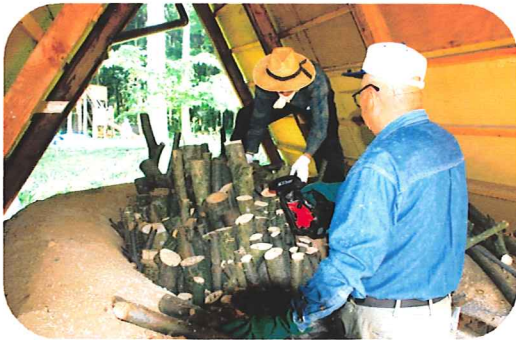
炭窯に材料が詰まり再度天井を作る準備が出来た
