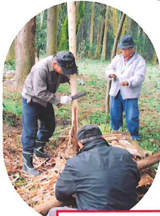
松丸太の皮を剥き2cmの厚さに輪切りしサンダーで磨く作業
