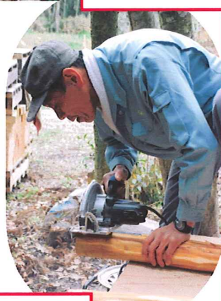
松丸太の皮を剥き2cmの厚さに輪切りしサンダーで磨く作業
