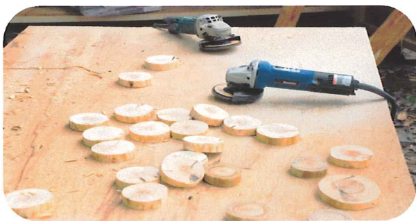
松丸太の皮を剥き2cmの厚さに輪切りしサンダーで磨く作業
